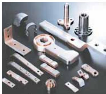
重電機器用電気接点の材料は、銅の高い電気伝導性や熱伝導性と、タンゲステンの金属では最も高い融点とを組み合わせた銅タンゲステン合金です。この合金は、当社が得意とする粉末冶金法で製造しています。
