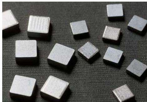
完成した銀系電気接点
