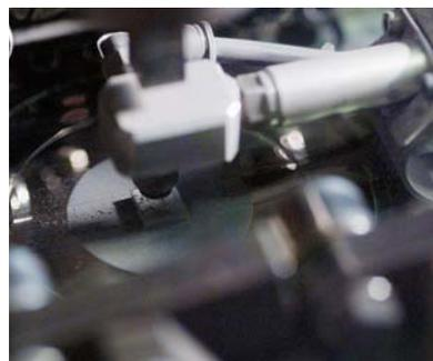
機械に投入された混合粉末は自動でプレス成型されます
