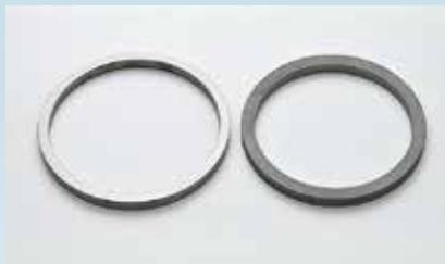
鏡面加工後のリング(左)と加工前のリング(右)
