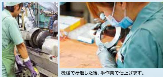
機械で研磨した後、手作業で仕上げます。
